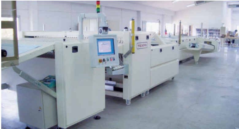
Die fertig montierte Textilfaltmaschine in der Montagehalle.
